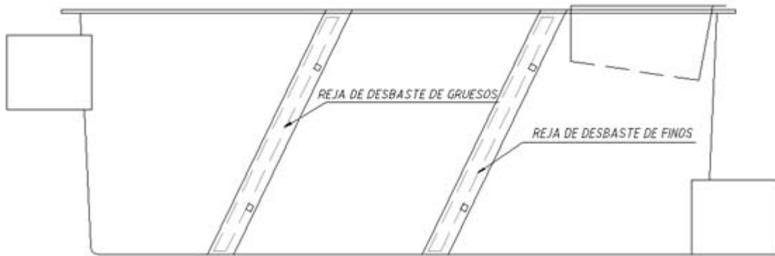
Figura 4.2: Canal de desbaste en la planta de tratamiento [19].
