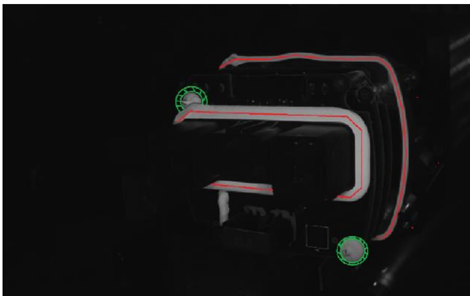
Figura 38: Exemple de criteris per considerar una peça com a NOK. Font: elaboració pròpia
