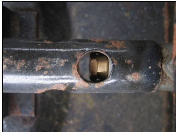
Figura 5.18 – Vista de l'injector i l'entrada d'aire primari al cremador Alejandro
