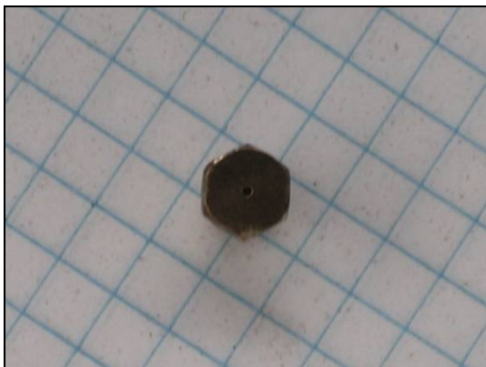
Figura 5.6 – Injectador d'una cuina GLP
