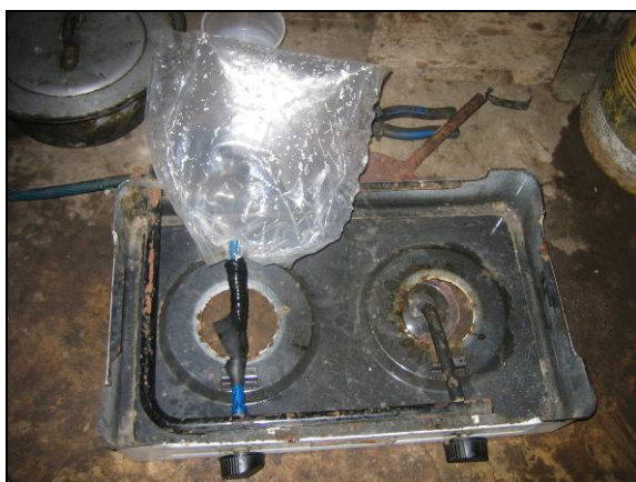
Figura 5.13 – Mesura de cabal. Bossa connectada a la sortida de l'injector.
