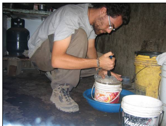
Figura 5.14 – Mesura de cabal. Desplaçament d'aigua amb la bossa plena de gas.
