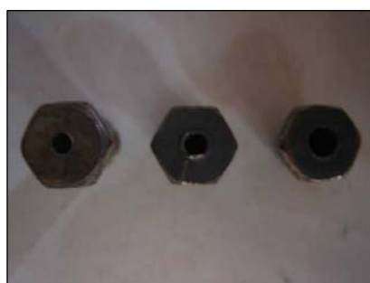
Figura 5.24 – Els tres injectors: d=2mm, d=2,5mm i d=3mm
