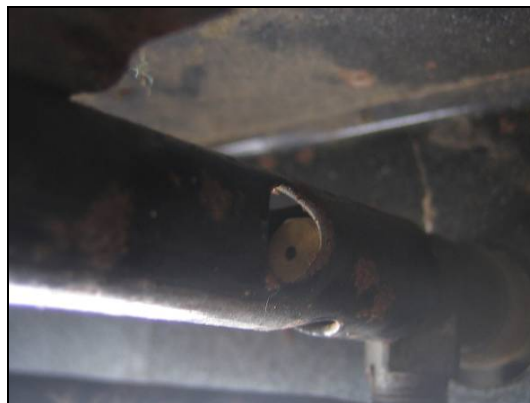
Figura 5.7 – Injectador i orificis d'entrada d'aire primari
