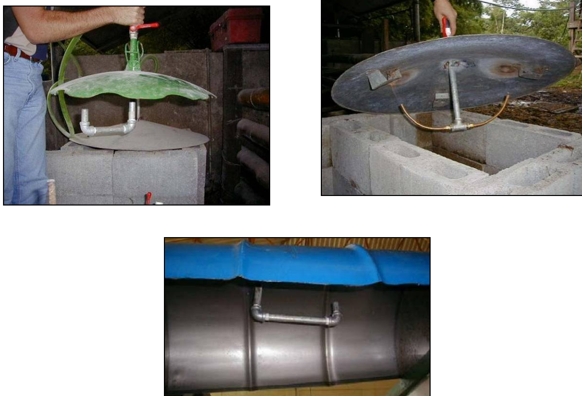
Figura 5.8 – Calefactores artesanals operats amb biogàs [40]
