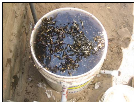
Figura 3.6 – Filtre ple d'aigua i rebliment per la prova de determinació del factor d'ocupació
