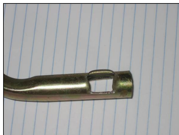
Figura 5.21 – Entrada d'aire primari del cremador Jorge
