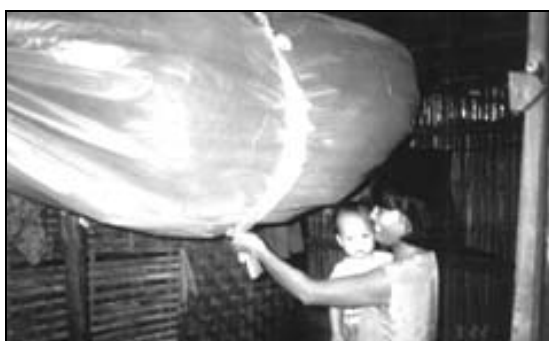
Figura 4.1 – Dipòsit comprimit amb un “cinturó”
