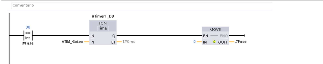
Figura 27. Bloque control desescarche
