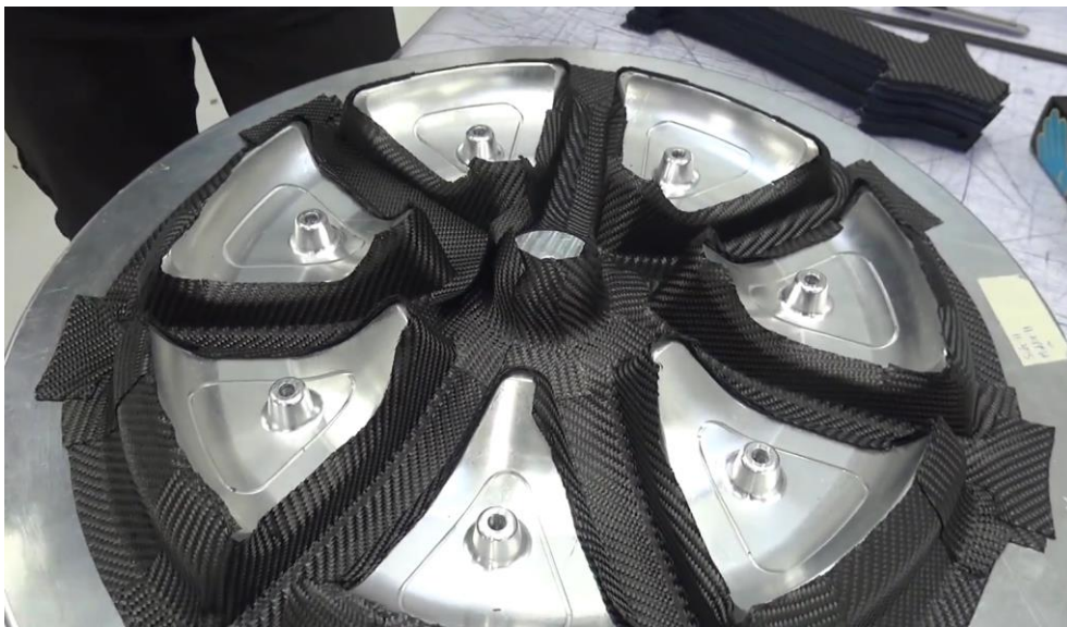
Figura 9. Col·locació de les làmines de fibra de carboni en un motlle frontal d'una llanta [11]
