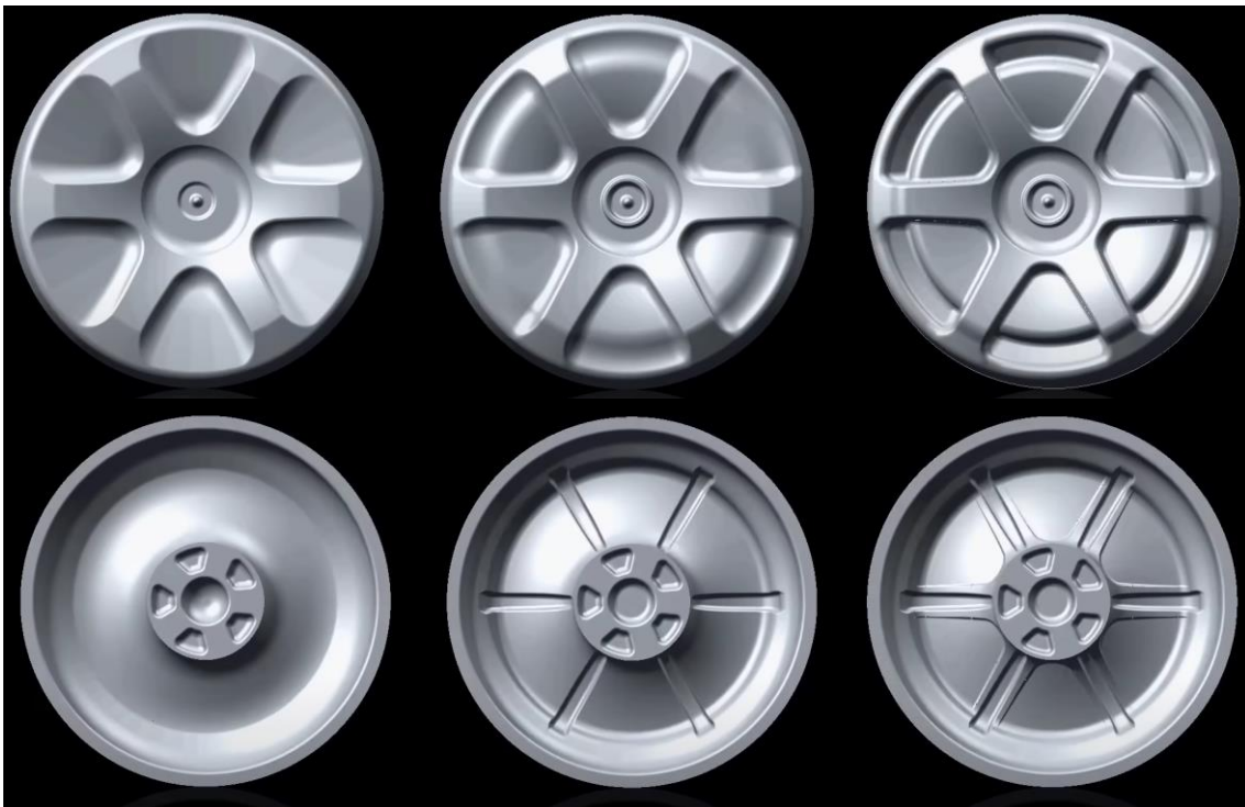
Figura 8. Renderitzat de les tres etapes de forjat d'una llanta RAYS [10]
