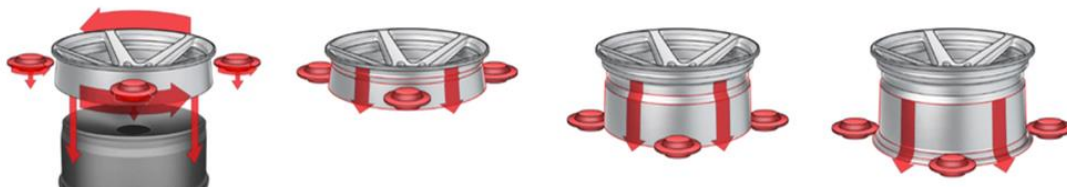
Figura 7. Seqüència del procés de flow forming [9]
