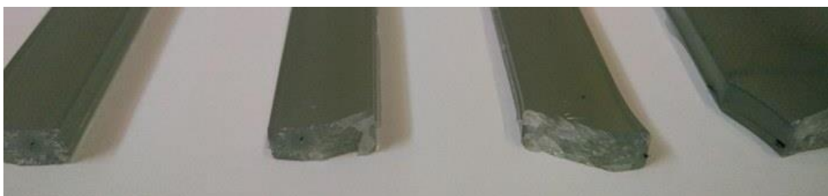
Figura 22. Aspecto de la ruptura frágil de las probetas de PET-R1
