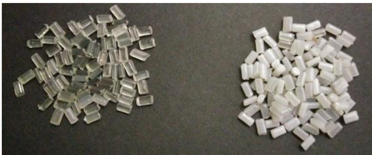
Figura 6. Granza de PET-R2 amorfa (izquierda) y recristalizada (derecha)
