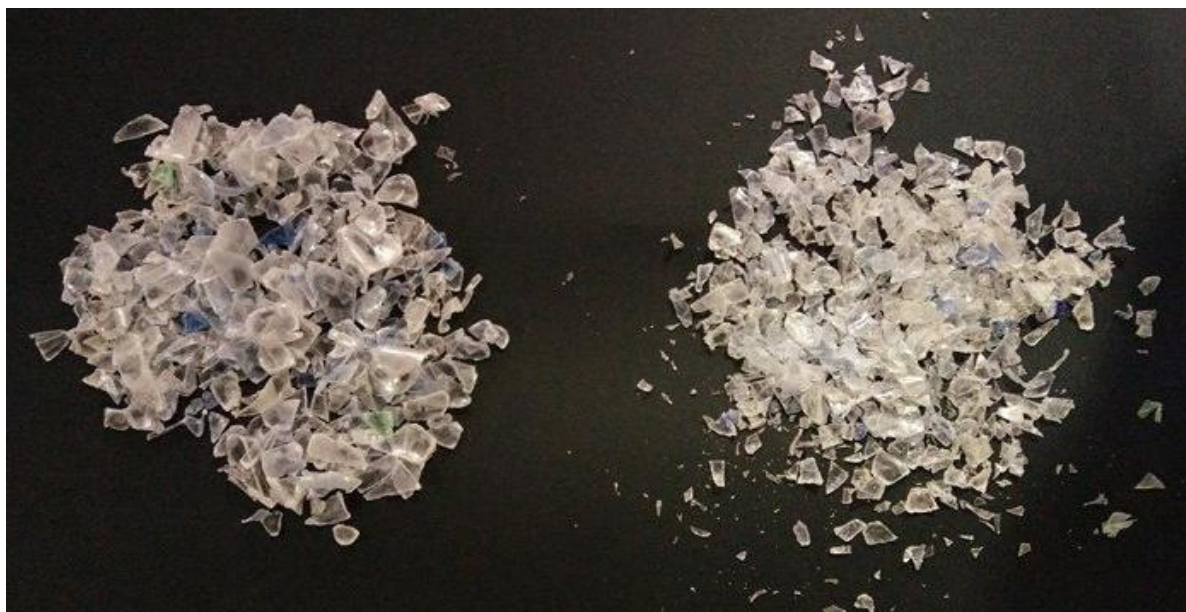
Figura 5. Escamas de PET-R2 iniciales (izquierda) y escamas de PET-R2 después de 5 pasos en el molino (derecha)
