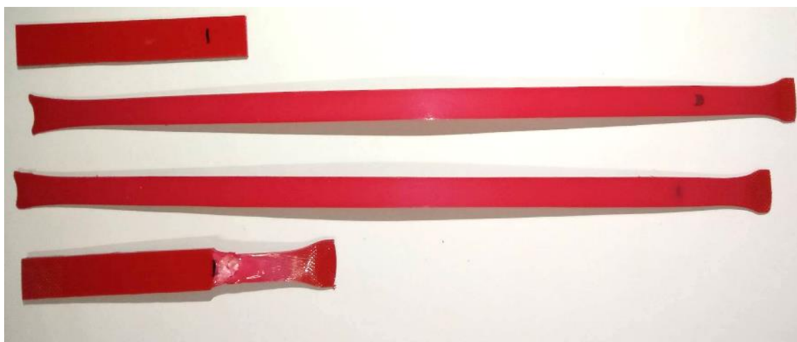
Figura 31. Aspecto de las probetas IQAP despu3s tracci3n.
