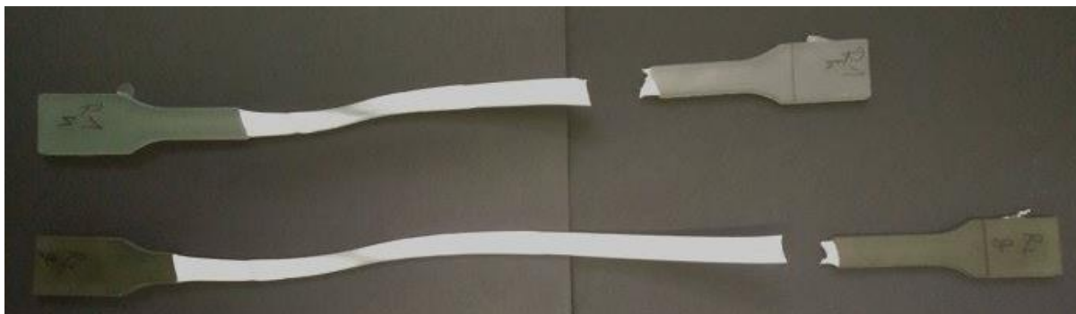
Figura 21. Aspecto de las probetas de PET-R1 (arriba) y PET-R2 (abajo) después ruptura (Ensayo 300 mm/min)
