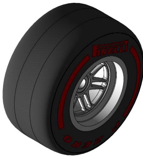
Fig. 5.4 Geometria del conjunt llanta i pneumàtic Font: creació pròpia
