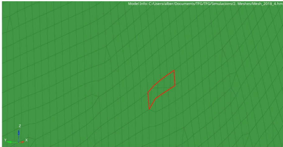
Fig. 5.10 Error en al mallat (la malla està oberta) Font: creació pròpia
