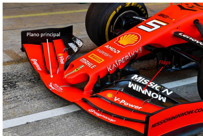
Fig. 4.1 Aleró davanter del Ferrari de 2019 Font: www.formula1.com (2021)
