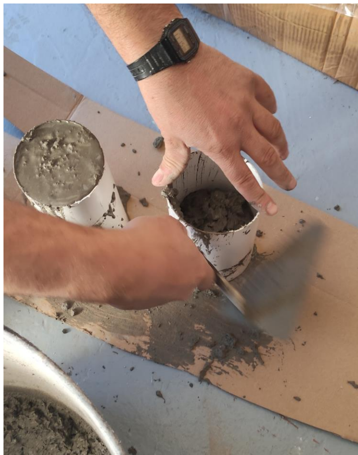
Figura 18. Fotografia del procés d'omplir les provetes
