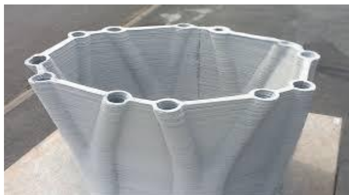
Figura 13. Il·lustració d'una peça realitzada amb el sistema Concrete Printing [15]
