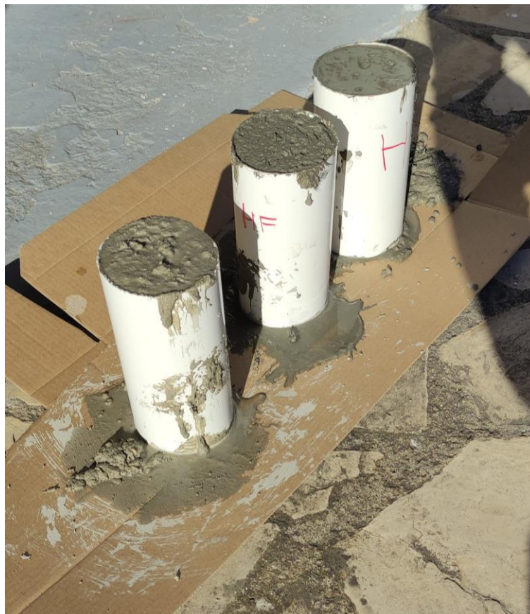
Figura 22. Fotografia del procés de curat de les provetes
