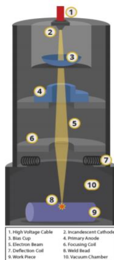
Figura 6 .Il·lustració d'una impressora EBM amb les seves parts [12]
