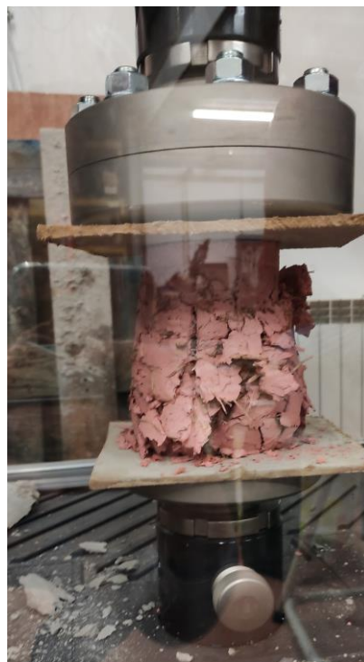
Figura 27. Fotografia de la proveta sotmesa al assaig de compressió simple
