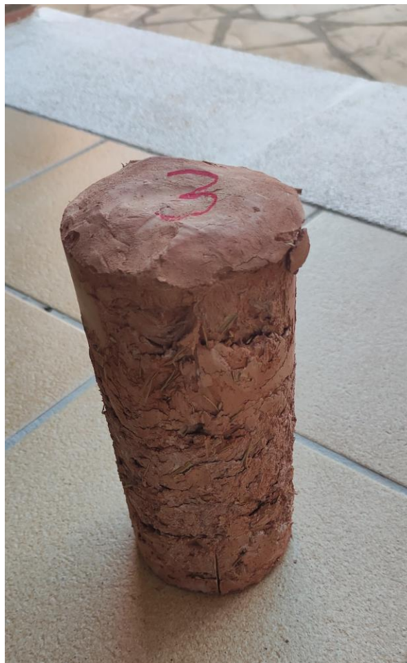
Figura 26. Fotografia de la proveta de tova finalitzada
