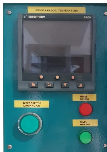
Figura 8.3. Panell de control de la cambra climàtica
