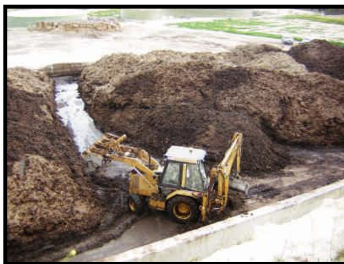
Ilustración 2.2. Sistema Windrow (Álvarez de la Puente, 2006).
