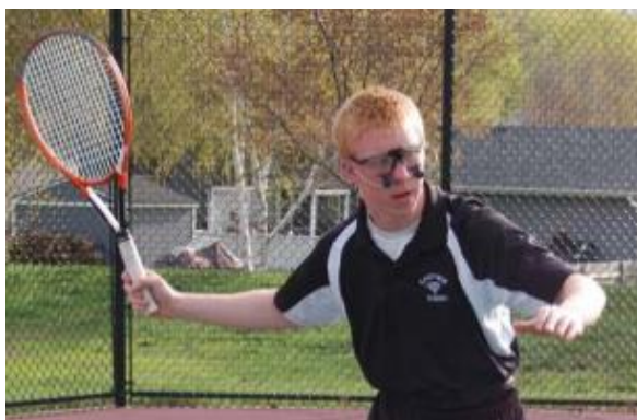
Figura 3.6 Eye-tracker EMR muntat sobre unes ulleres i sobre una gorra. [33]
