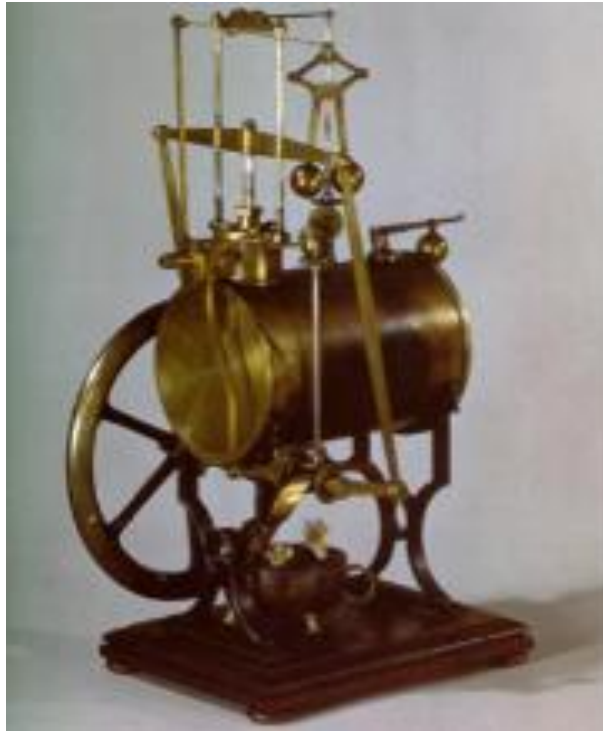
Imagen 7: Regulador centrífugo de James Watt.
