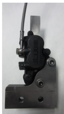
Fig. 4.4.2. Detall de la col·locació de la pinça.
