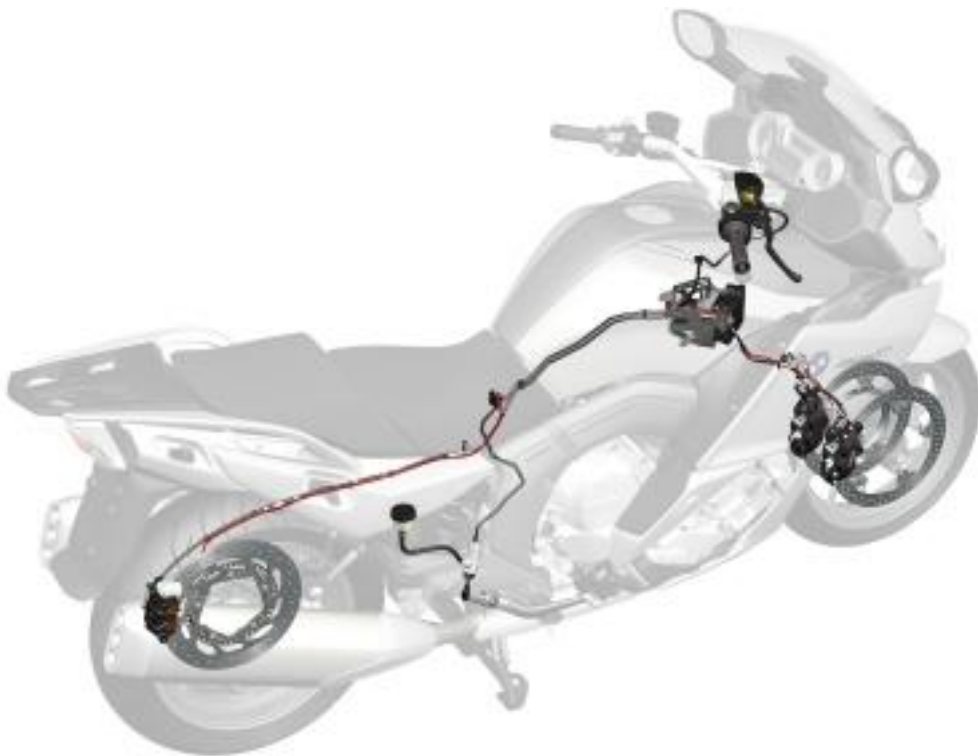
Fig. 1.1.1. Il·lustració d'una motocicleta amb els components del sistema de fre hidràulic.
