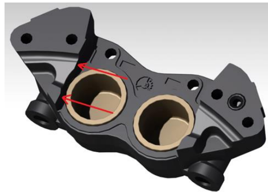
Fig. 2.2.4. Recolzament de les pastilles en una pinça fixa
