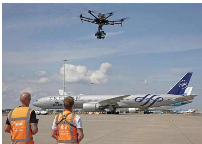
Figura 2.7. Dron de inspección en el aeropuerto de Ámsterdam-Schiphol. (Ver [57])
