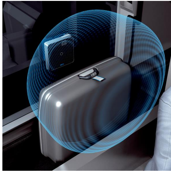
Figura 1.7. Lectura RFID de la etiqueta del equipaje durante su facturación. (Ver [35])
