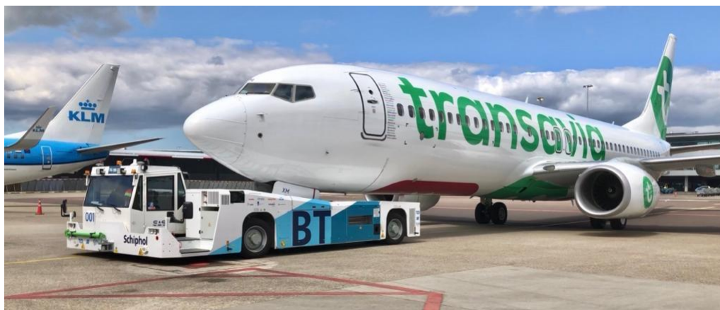
Figura 2.2. TaxiBot remolcando un Boeing 737 de Transavia. (Ver [43])
