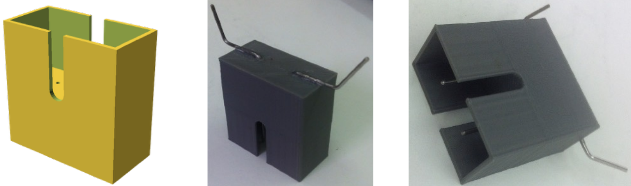
Fig 11. Cap de mesura realitzat amb impressió 3D
