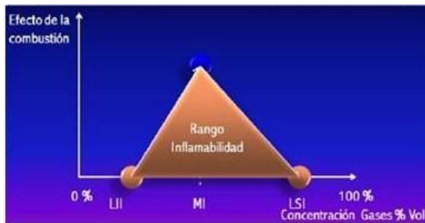
Ilustración 18: Detalle de los rangos de inflamabilidad de los gases
