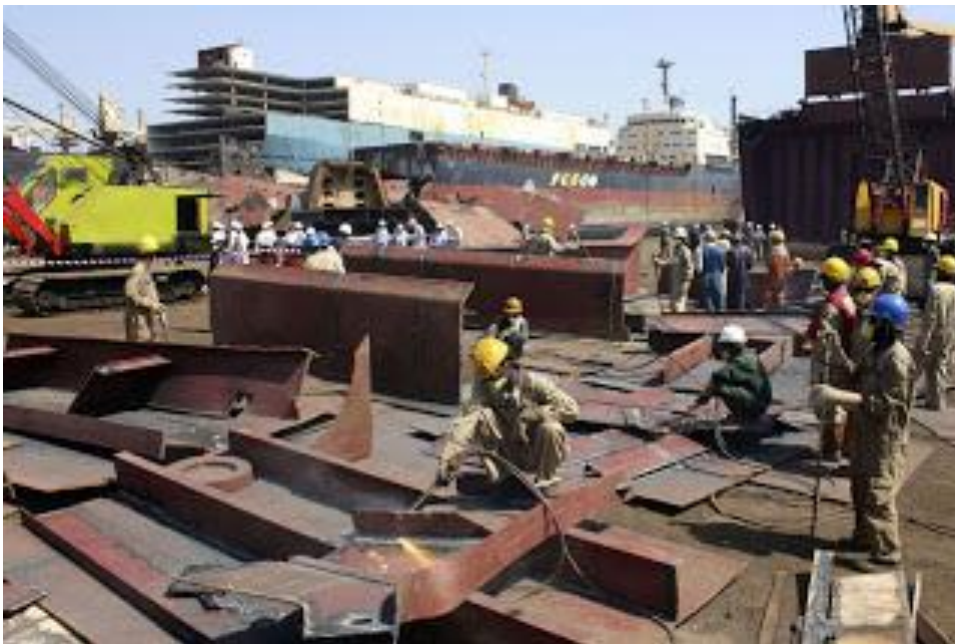
Ilustración 7: Despiece del material de los barcos por trabajadores de Alang
