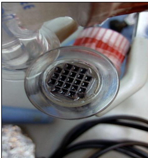
Figura 13. Monolito 100 cpsi sumergido en agua residual de cerveza dentro del fotoreactor.
