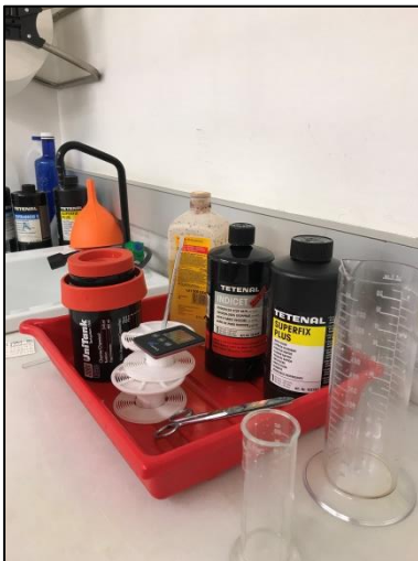
Figura 19. Elements utilitzats per fer el revelat del negatiu. La imatge inclou: líquids, tanc de revelat, tissores, cronòmetre, espiral, termòmetre i provetes
