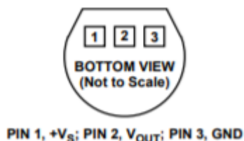
Figura 4-13. Patillatge TMP35 (Font [31]: www.analog.com/)
