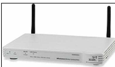
Access Point del fabricante 3com
