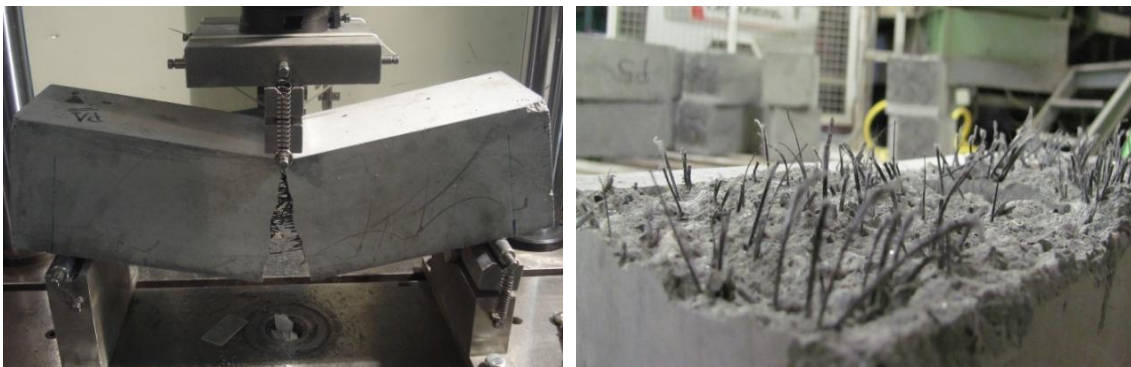
Figura 1.1 – Macro-fibras plásticas (estructurales) en el hormigón
