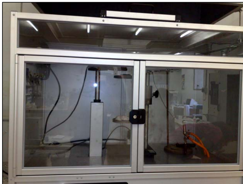
Foto 7.2. Cabina estanca para la realización del ensayo.
