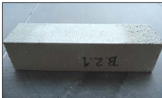
Foto 4.5. Probeta tras una primera capa de adhesivo de dos componentes
