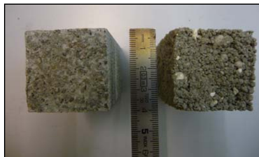
Foto 5.3. Zona de rotura en probetas mixtas de mortero modificado con hidromagnesita gruesa
