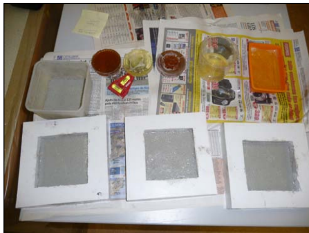
Foto 3.8. Curado a nivel de probetas de mortero epoxídico
