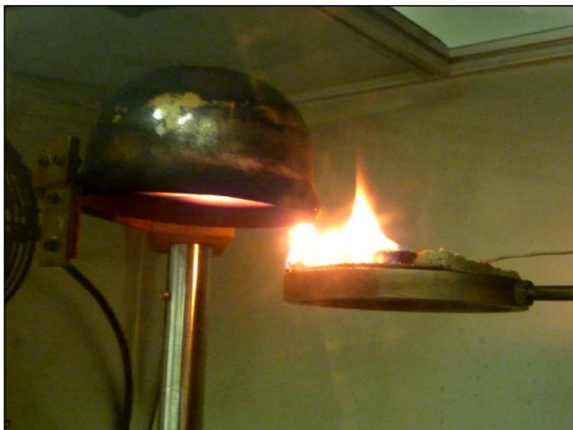
Foto 7.3. Probeta inflamada durante el ensayo de goteo.
