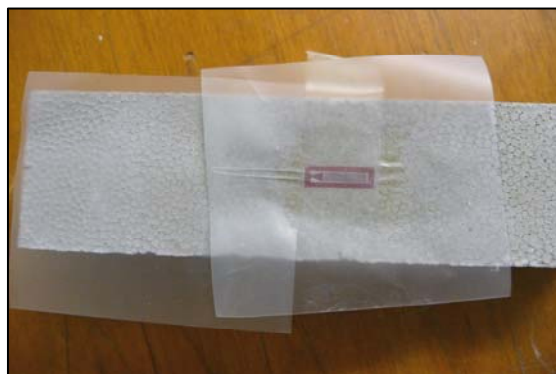
Foto 4.6. Protección de la galga
