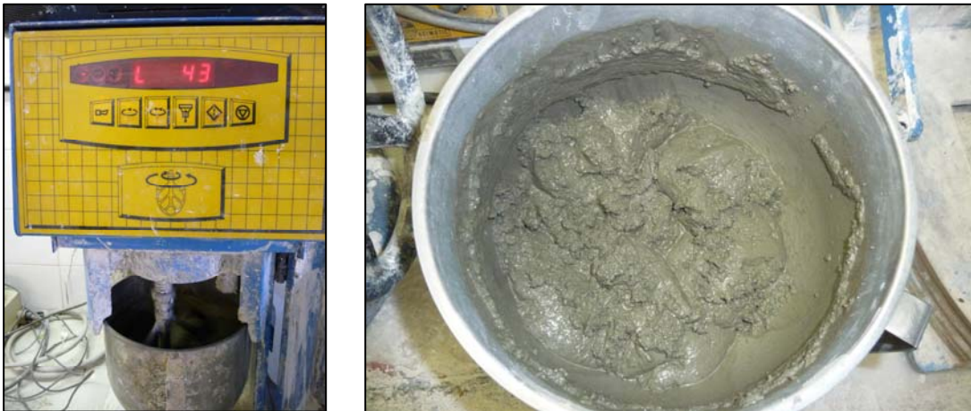
Foto 3.3. Amasada de mortero de cemento portland
