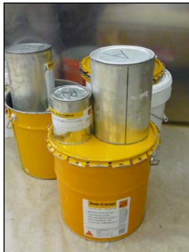
Foto 3.1. Mortero epoxídico Sikadur 42 anclajes
