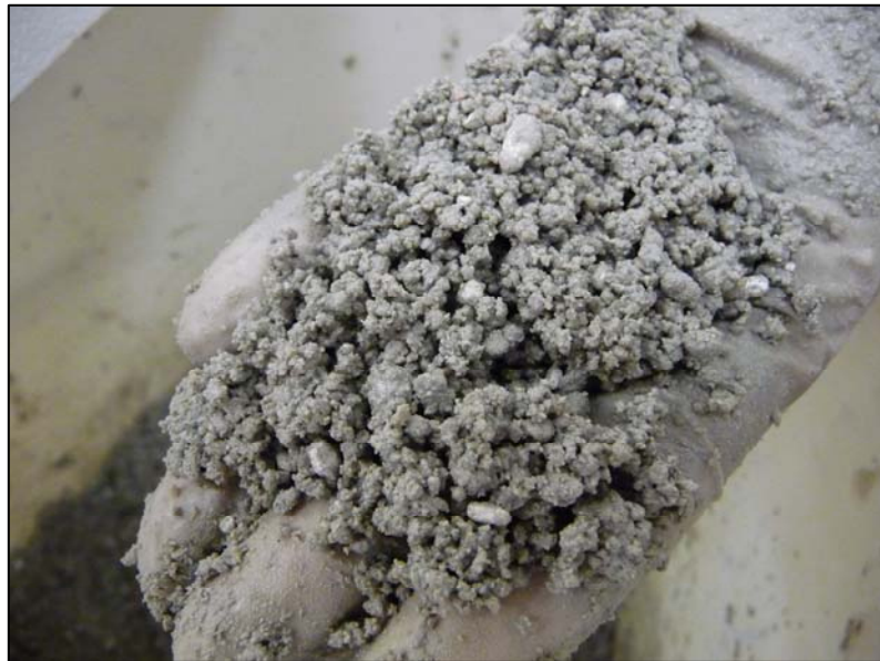
Foto 3.11. Mortero epoxídico modificado con Hidromagnesita Gruesa
