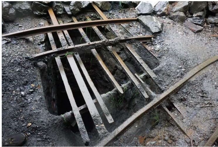
Figura 8. Buzón de recepción del material que proviene de mina en la Cooperativa Aurífera de Cotapata.
