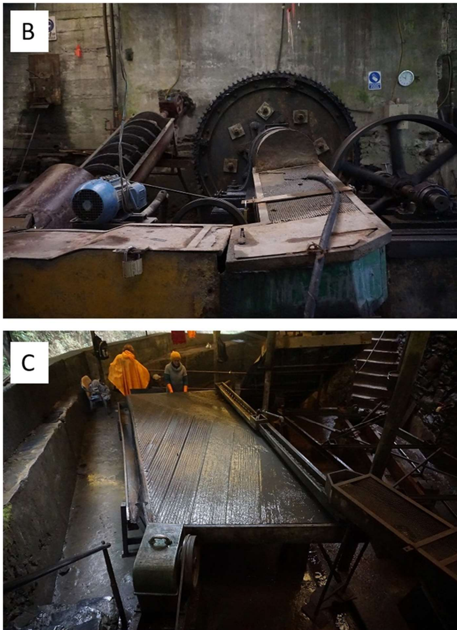
Figura 10. Elementos de la planta de procesamiento de la Cooperativa Aurífera de Cotapata. A) Molino de Bolas. B) Espiral. C) Shaking Table.
