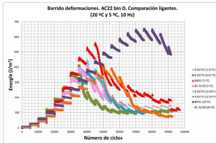
Figura 12. Ejemplo resultado EBADE disipación de energía. (Salazar, 2012).
