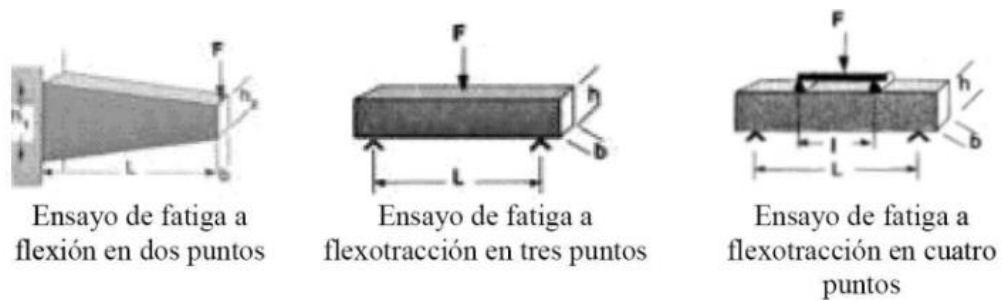
Figura 5. Procedimientos para determinar el comportamiento a fatiga. flexión
