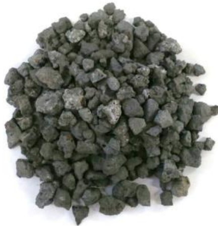
Figura 8. Foto árido siderúrgico (Mendez, B UPC 2015)
