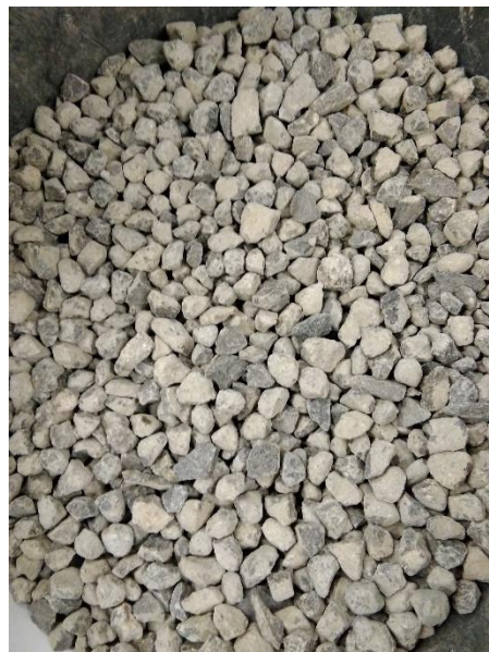
Figura 7. Foto árido convencional
