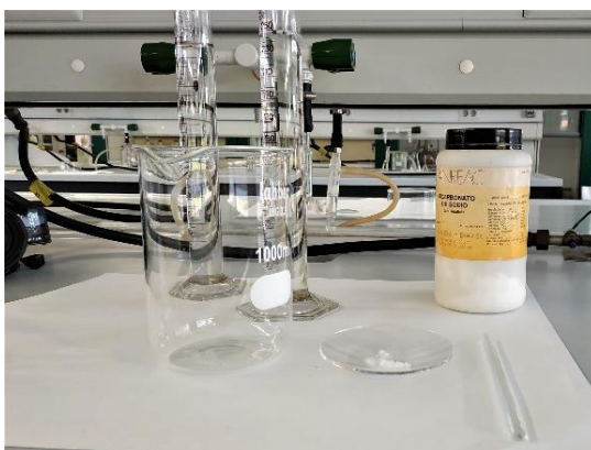
Figura 24. Preparació de la dissolució al 0.1% en bicarbonat de sodi. (font: pròpia)
