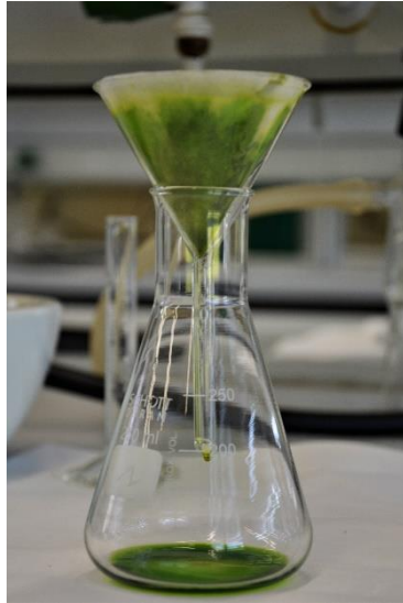
Figura 16. Filtració fulles verdes. (Font: pròpia)
