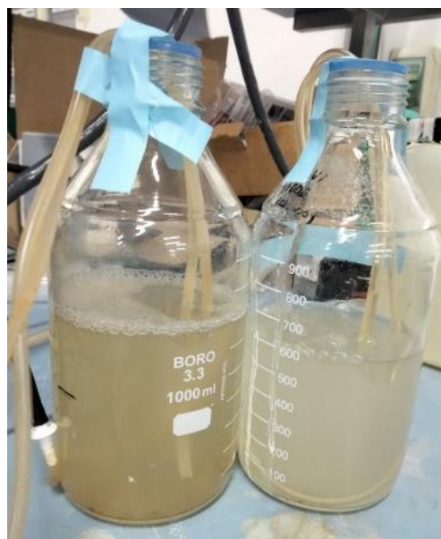
Figura 8. Ampolles de recirculació dels compartiments dels càtodes de les MECs (Cel·les d'Electròlisi Microbiana). Font: Elaboració pròpia.
