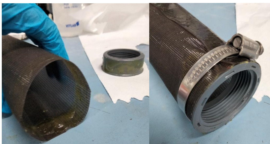
Figura 6. Assemblatge del tap de PVC a la membrana de la MEC (Cel·la d'Electròlisi Microbiana) gran. Font: Elaboració pròpia.
