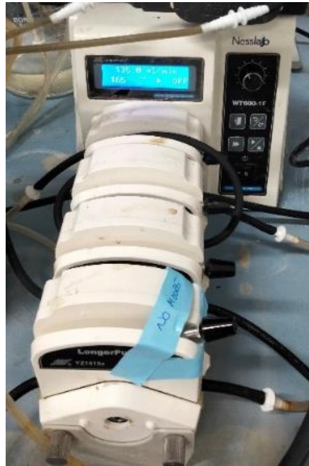
Figura 7. Sistema de recirculació del càtode a 135 rpm. Font: Elaboració pròpia.
