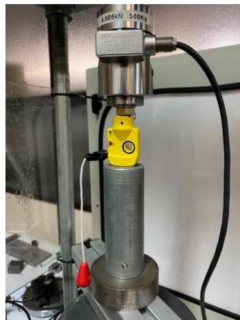
Figura 14. (Foto) Prova dinamomètrica del perforador
