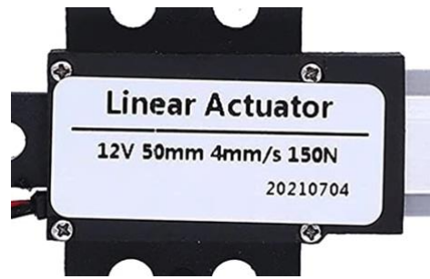
Figura 19. (Foto) Característiques nominals de l'actuador
