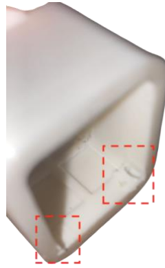
Figura 76. Suports de la carcassa tallats
