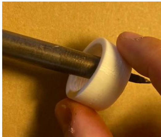
Figura 68. S'escalfa l'interior de la rosca
