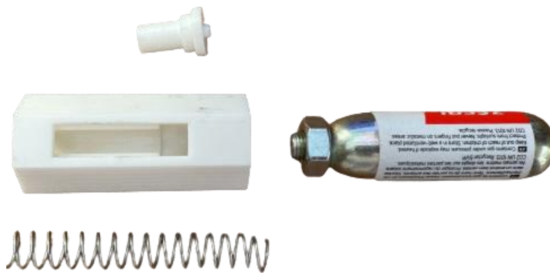
Figura 57. Actuador elàstic desacoblat
