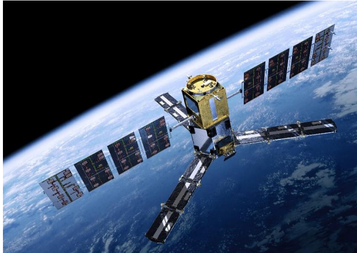
Figura 3. Imagen artística del satélite SMOS que lleva embarcado el radiómetro interferométrico MIRAS (Microwave Imaging Radiometer by Aperture Synthesis) [22].
