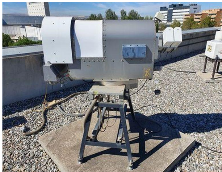
Figura 2. Radiómetro de microondas diseñado en el laboratorio CommSensLab, toma medidas desde tierra. Está situado encima módulo D3 Campus Nord [21].
