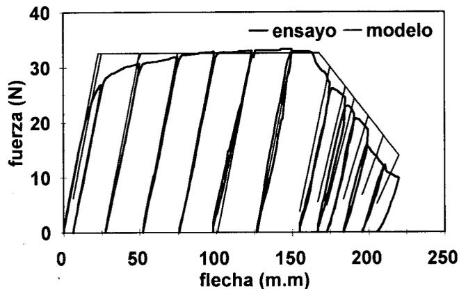
Figura 7. Comparación entre ensayo y modelo con endurecimiento
