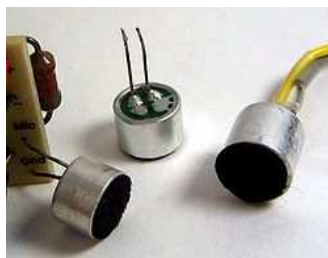
Fig.3.1 Foto de varios micrófonos electret
