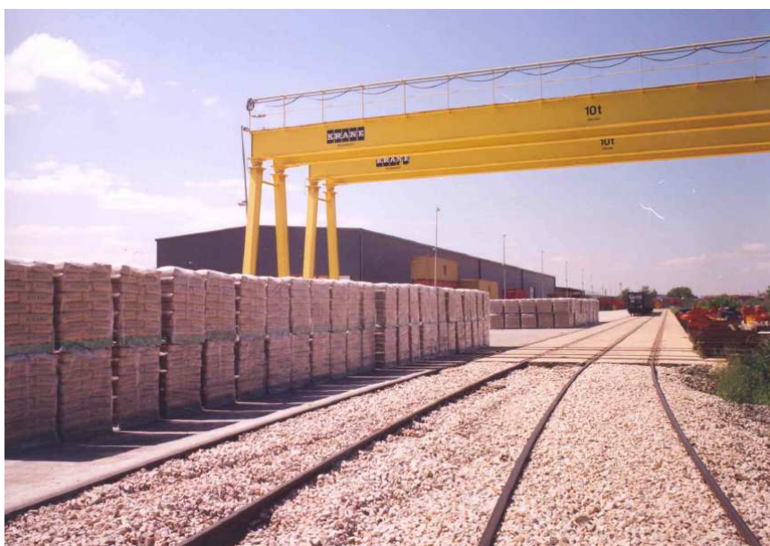
fig.1.5.Puente grúa y mercancía paletizada
