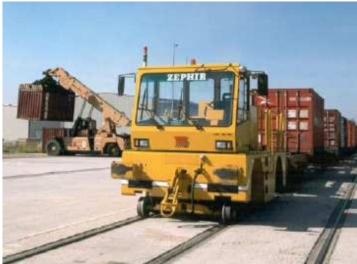
fig.1.3.Locomotora para traer la mercancía hasta las vías interiores.
