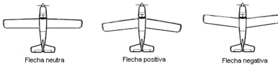
Fig. 4.1 Tipos de flecha para una aeronave
