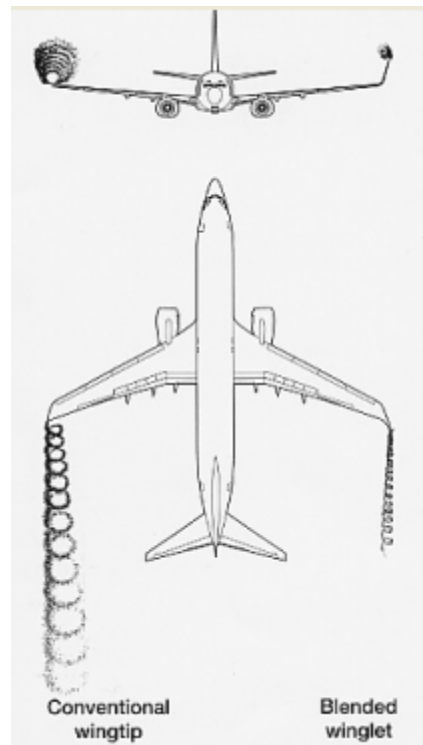
Fig. 4.7 Efectos aerodinámicos del winglet
