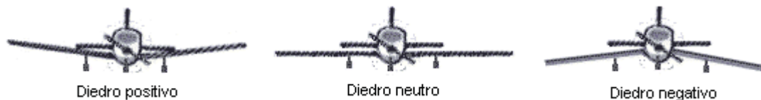
Fig. 4.4 Tipos de diedro en una aeronave
