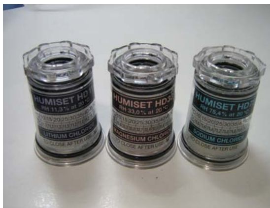
Fig. 4.4 Sales para calibrar el sensor de humedad (HS1101)
