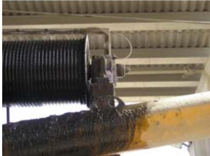
Detall del rodet de cable i del rodament que el suporta en un dels seus extrems.
