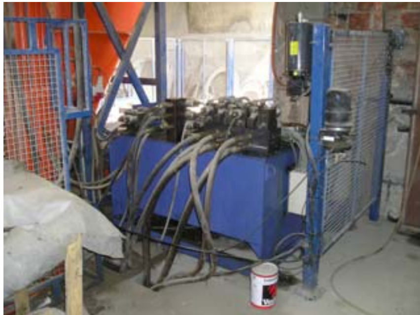
La imatge mostra el grup de pressió hidràulic d'una de les màquines de fer tubs.
