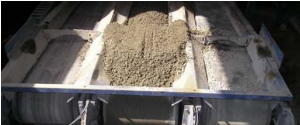
A la imatge es veuen les tres cintes, en paral·lel, que alimenten la màquina.
