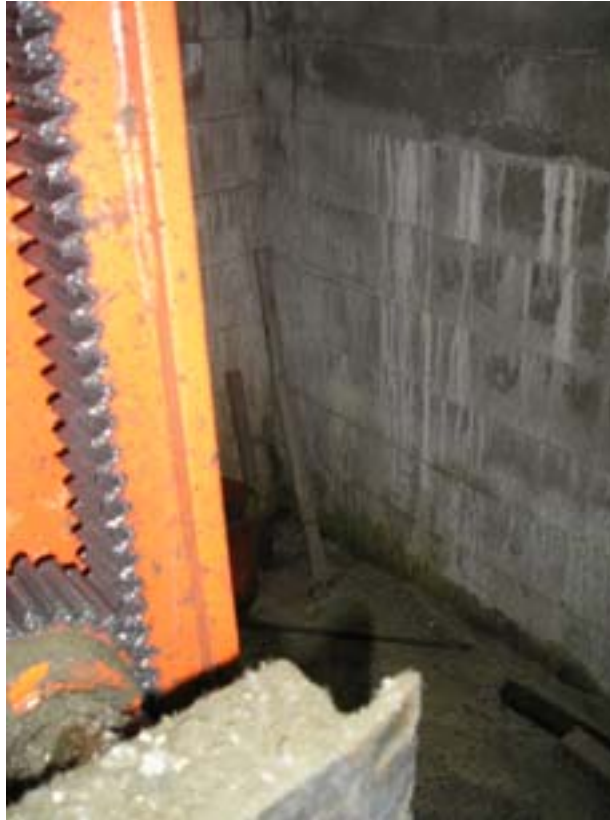
A la fotografia es veu la cremallera que suporta una de les columnes del bastidor d'una màquina de fer tubs.
