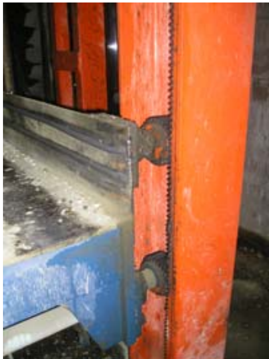
Imatge del sistema de doble pinyó de anivellament del motlle.
