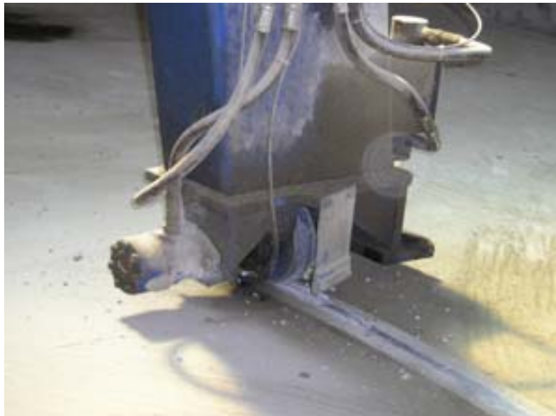
Detall de l'altre extrem del bastidor de la premsa. Veiem una de les rodes sobre el rail.
