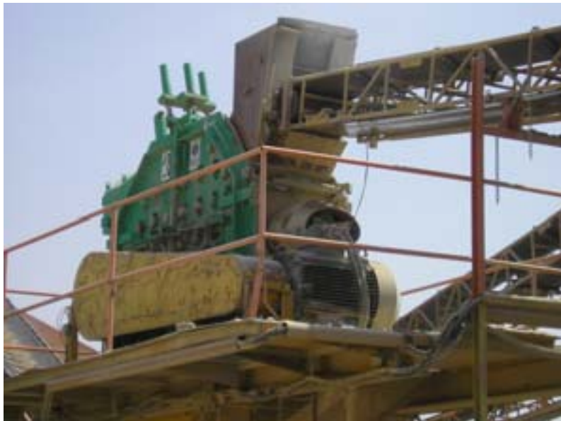
A la fotografia podem veure un dels molins amb el carenat que protegeix les corretges que l'accionen (en groc)
