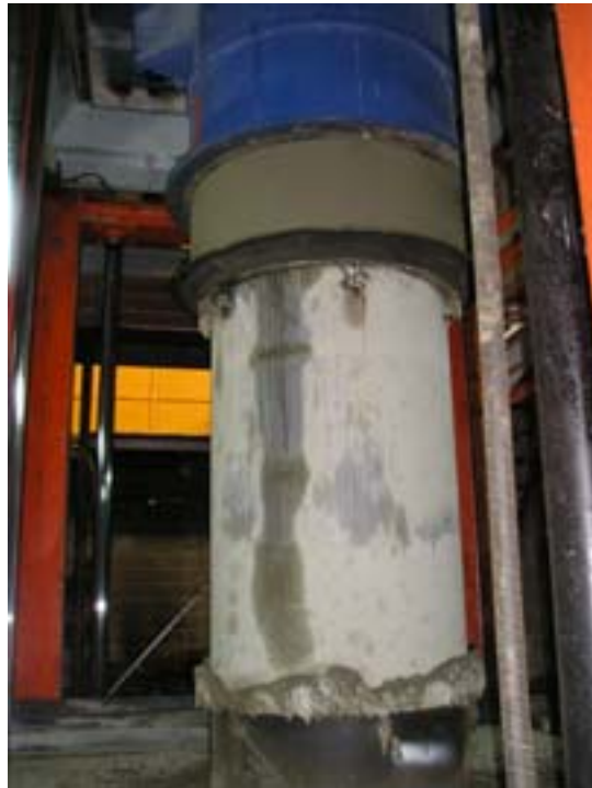
A la fotografia veiem el motlle interior unit a la taula, a nivell de terra.
