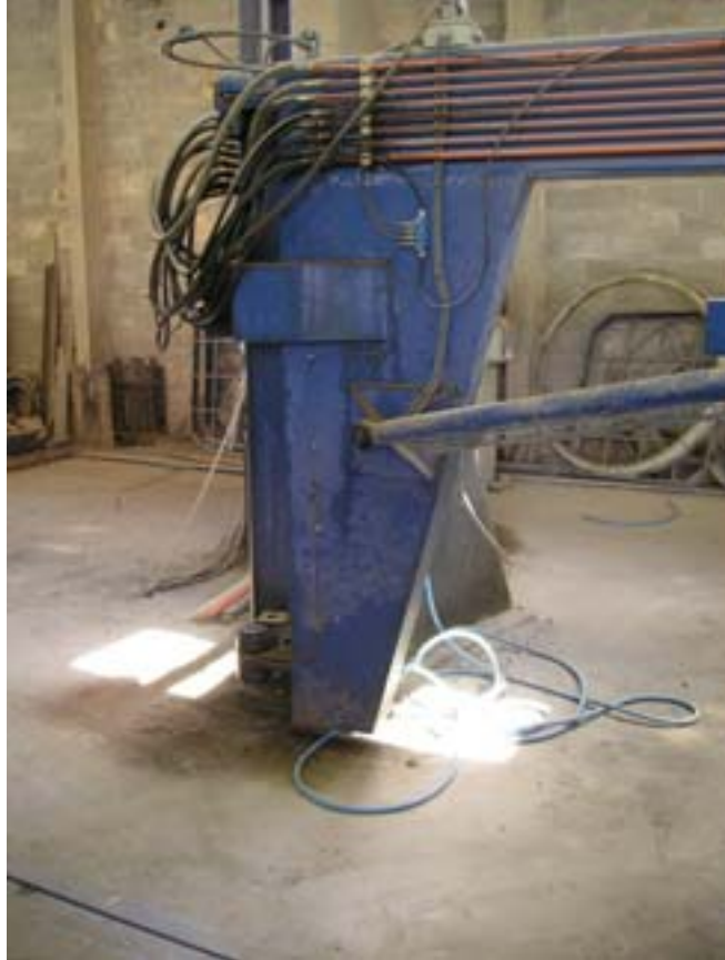
Imatge del punt de pivotatge del bastidor de la premsa.
