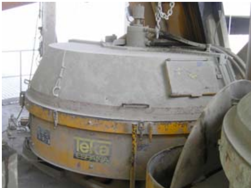
L'altre pastera situada al costat de la mostrada a la fotografia superior. Les dues pasteres corresponen a les màquines 2 i 3 de fer formigó.
