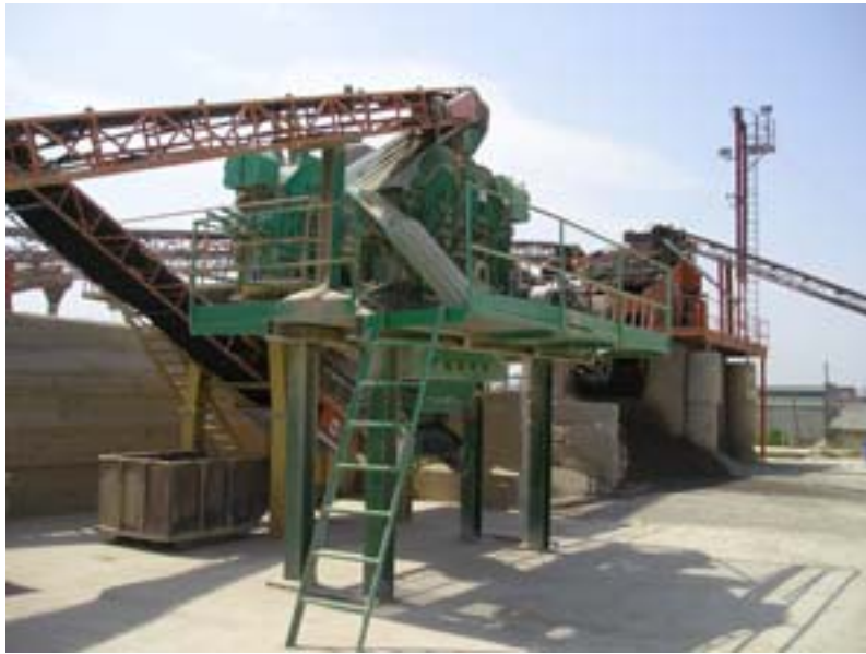
A la fotografia podem veure els dos molins (en verd) l'un al costat de l'altre.
