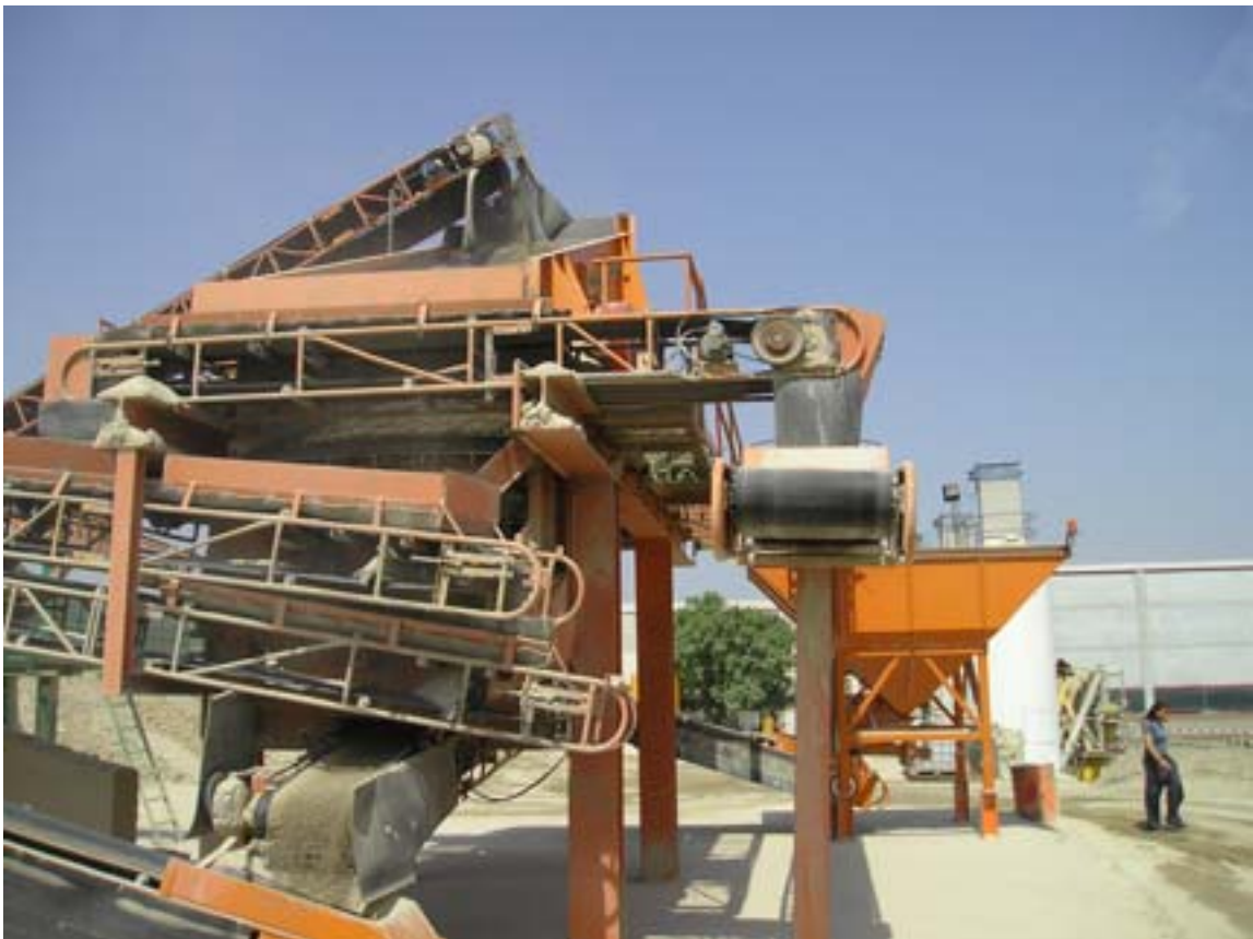
A la part dreta de la fotografia, i en color taronja, veiem la tolva secundària.
