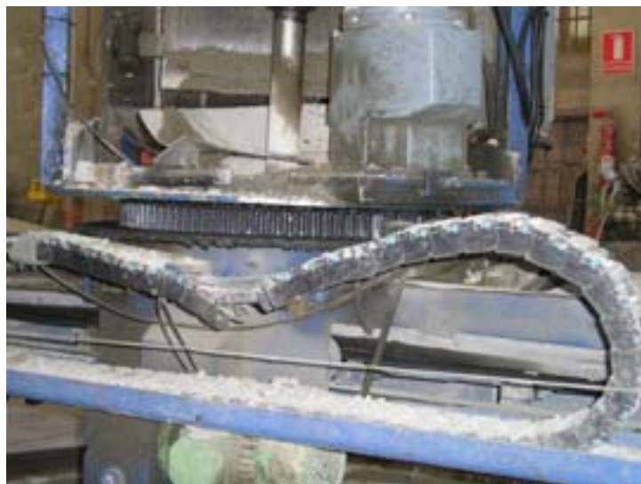
Detall de la corona que acciona la cinta giratoria.
