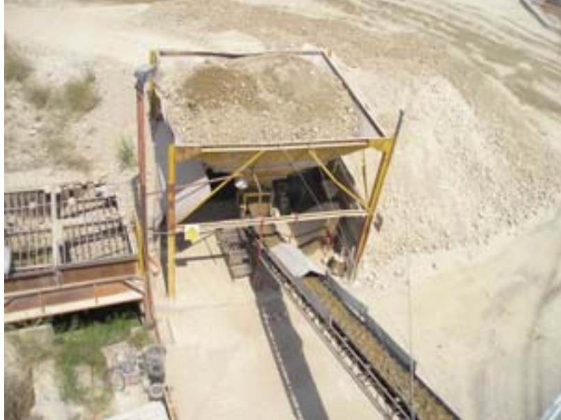
A les fotografia es veu en groc la tolva d'alimentació des de sobre.
