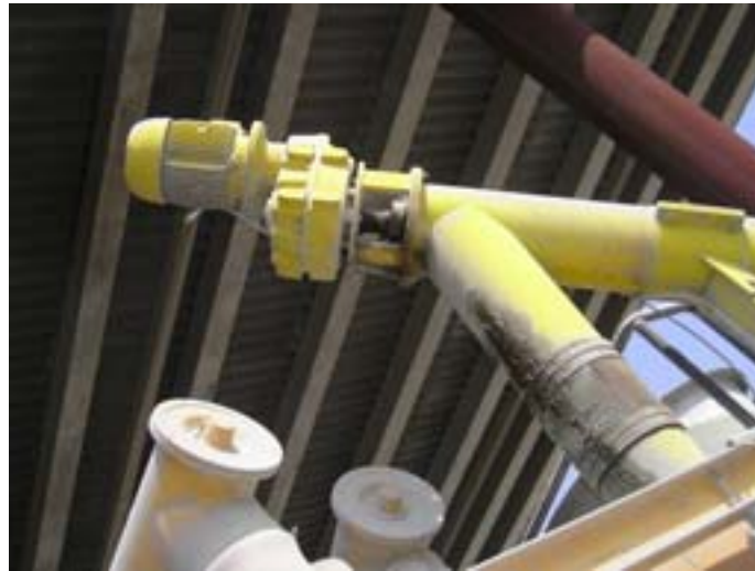
Imatge d'un bisenfi d'additiu en l'extrem de descàrrega.
