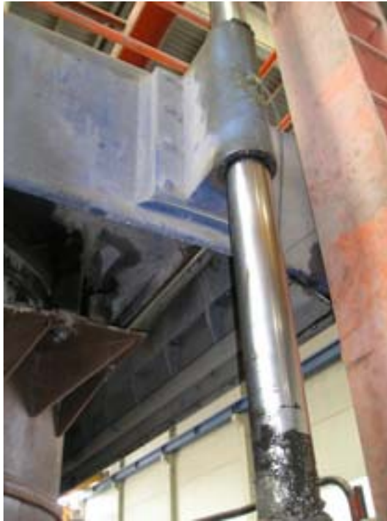
Imatge de la corredera del motlle (del doble d'alçada que la de la premsa)
