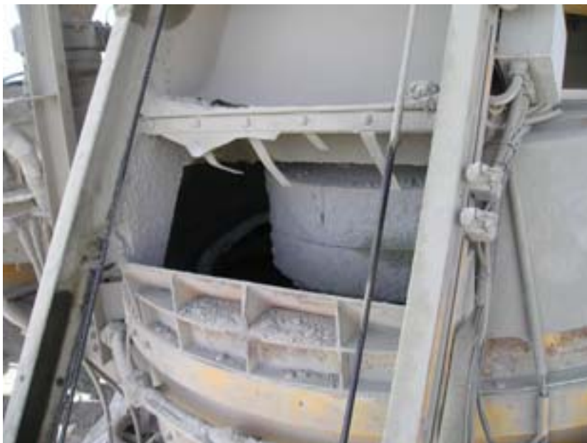
A la fotografia es la comporta per on la vagoneta aboca el material a la pastera.
