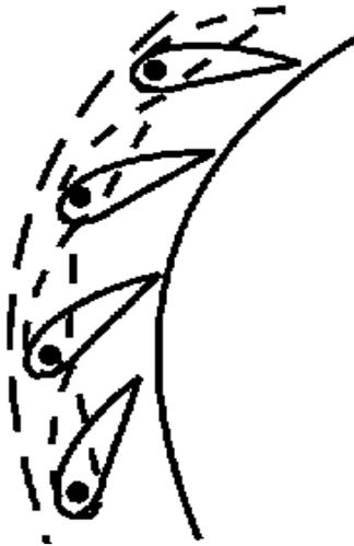
**Figura 4:** el dibujo esquemático muestra las directrices en posición abierta (líneas continuas) y en posición cerrada (líneas discontinuas). En esta última posición la extremidad de un álabe se apoya completamente sobre el flanco del anterior, cerrando prácticamente el paso del agua al rodete.
