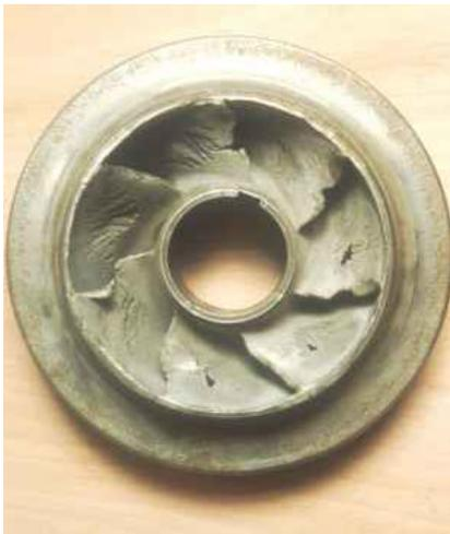
Desde el punto de vista de utilización, si la cavitación es inevitable, hay que saber si un determinado diseño de máquina, aunque con algunas restricciones, puede funcionar dentro de patrones aceptables. A menudo, la operación con alguna cavitación se tolera debido a necesidades operacionales. [2]
