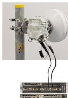
Figura 5. 27 Alimentació del MPT mitjançant 2 cables
