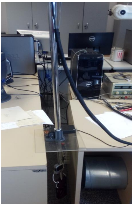
Figura 4. Sistema complet, es poden apreciar tots els components. De dalt a baix, perxa, base amb l'encoder,
