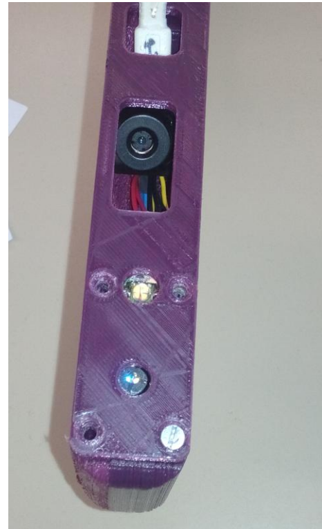
Figura 2. Detall d'un costat del capçal on es veuen, de dalt a baix, la càmera, el LED d'il·luminació i el LED vermell.
