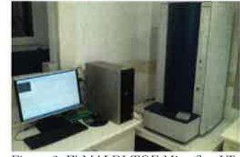
Figura 2. El MALDI-TOF Microflex LT (BrukerDaltonics) realizando una detección de proteínas.
