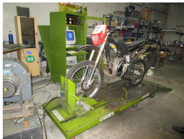
Fotografia 3. Rieju pujada al banc de proves MOTOLAB.
