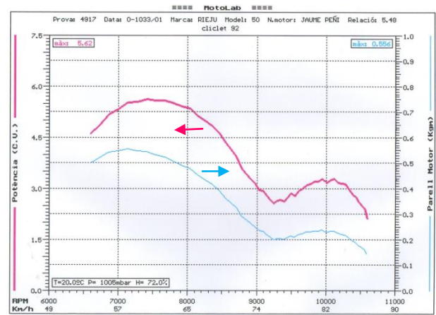
Gràfica 1. Corbes de potència i parell del motor reconstruït de sèrie.
