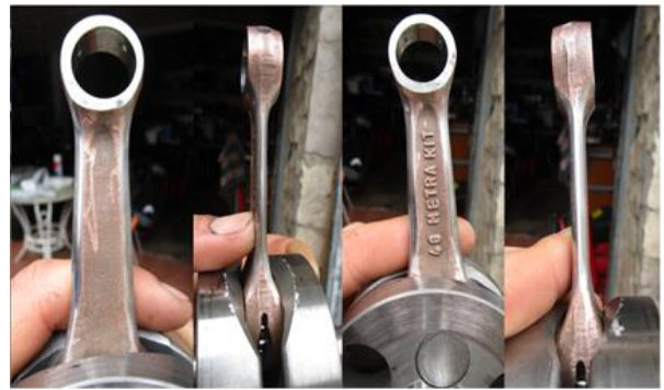
Fotografia 4. Biela amb els cantons polits i acabats en punta.
