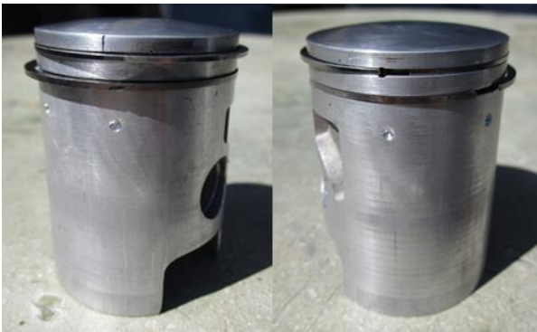
Fotografia 7. Pistó amb els forats de lubricació.
