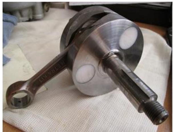
Fotografia 5. Cigonyal MK planificat i amb els forats tapats.
