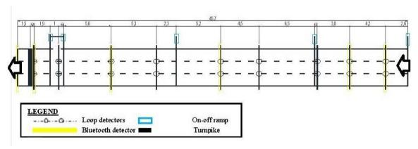
Fig. 4. Test site layout
