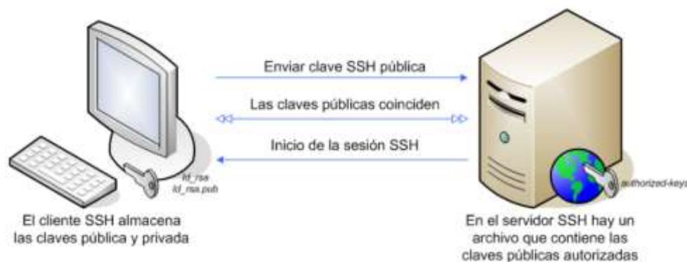
Figura 9: Funcionamiento del protocolo SSH [11].
