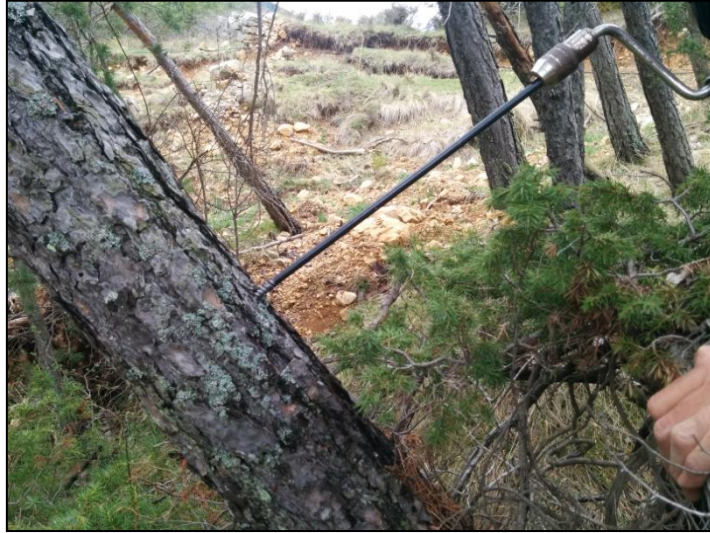
Figura 15. Extracció de la mostra amb barrina Pressler. Font pròpia.
