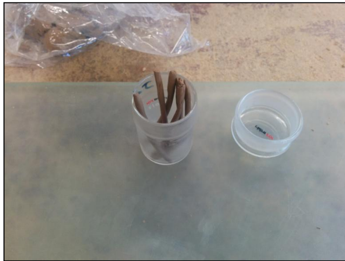
Figura 21. Cilindres de material formats seguint el procediment esmentat i abans de ser assecats. Font pròpia.
