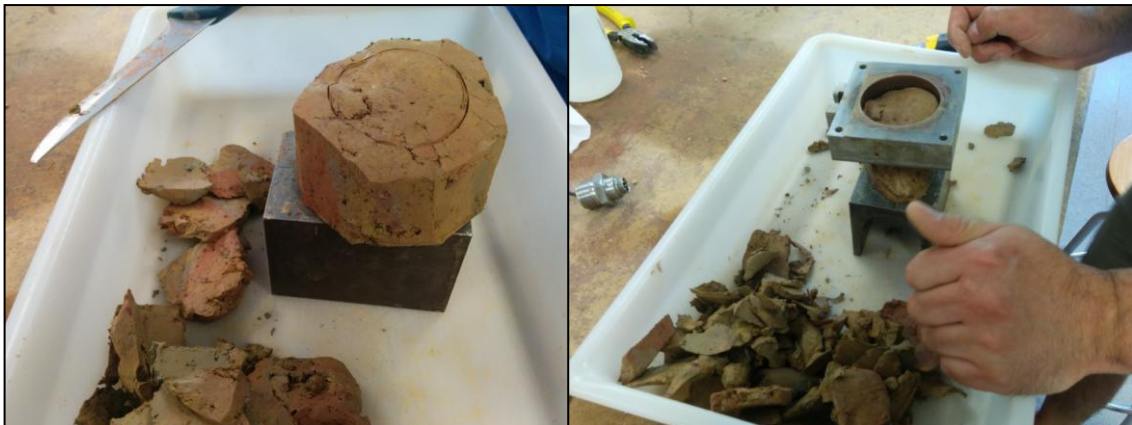
Figura 26. Procediment de preparació de la mostra per introduir-la a l'anell de l'equip de tall directe. Font pròpia.
