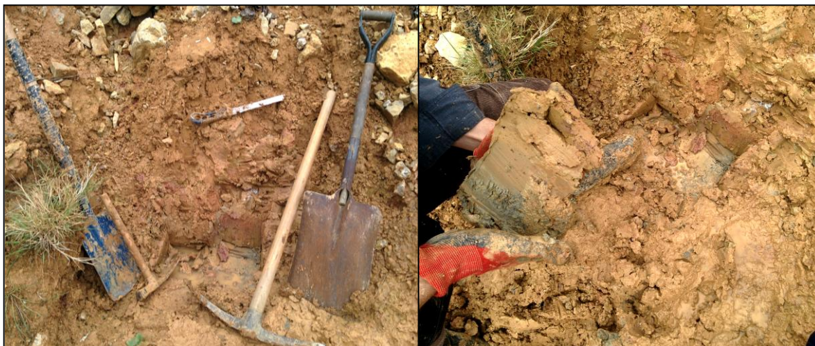
Figura 17. Fotografies d'una mostra-bloc, de la zona on es va extreure i de les eines utilitzades. Font pròpia.
