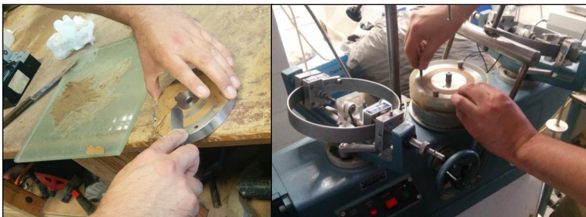
Figura 24. Introducció de la mostra al motlle i col·locació de l'anell a l'aparell de tall anular. Font pròpia.
