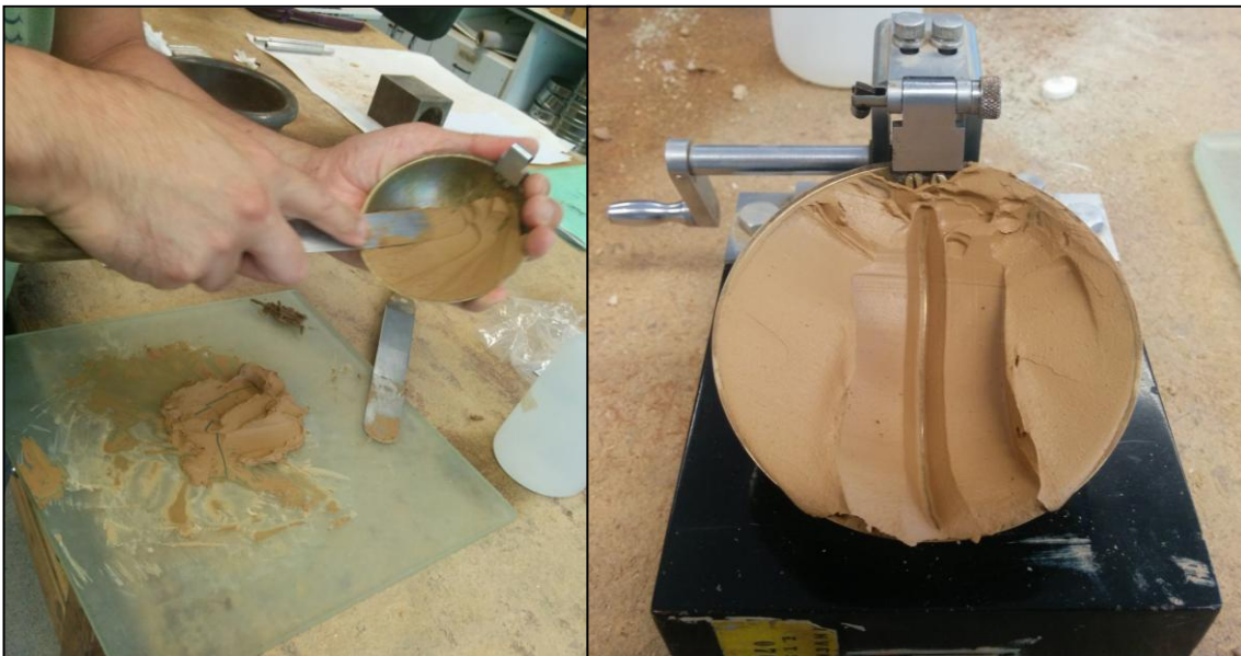
Figura 20. Procediment d'estendre el material dins la cullera i mostra preparada per ser assajada. Font pròpia.
