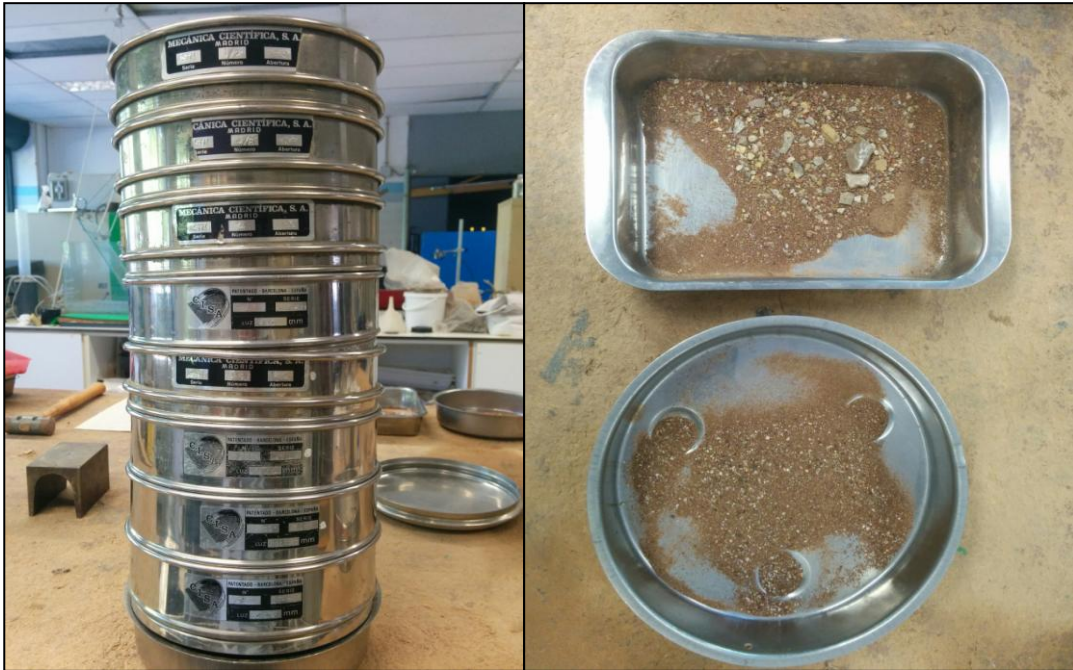
Figura 18. Sèrie de garbells utilitzats / Mostra de grossos i fins per separat, un cop assecades al forn. Font pròpia.
