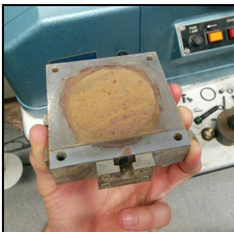
Figura 27. Anell amb el material, llest per col·locar-lo a l'equip de tall directe. Font pròpia.
