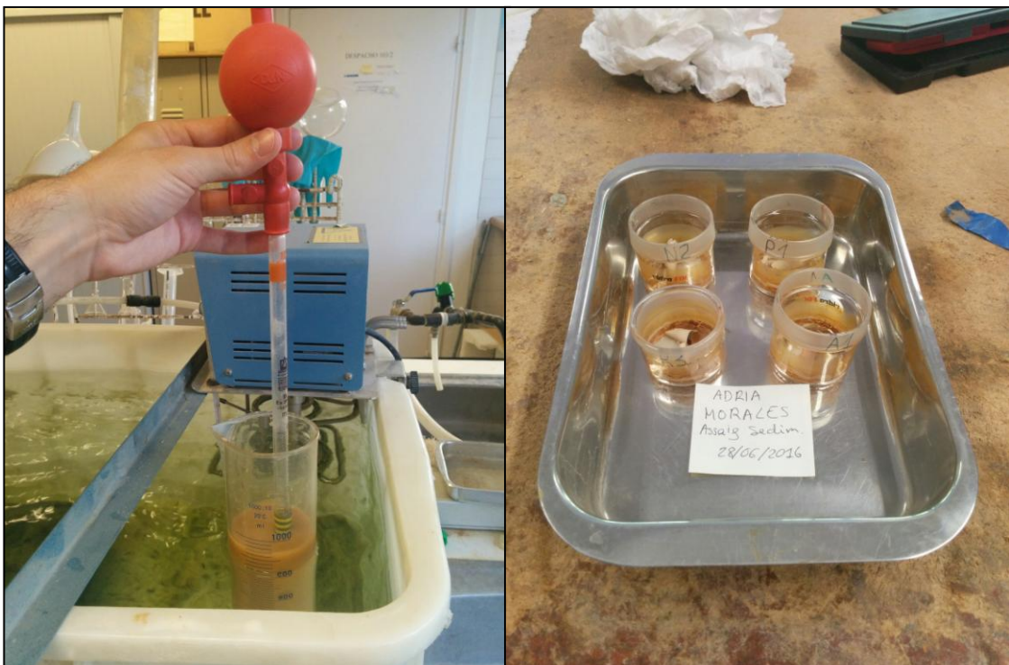
Figura 19. Extracció d'una mostra de la proveta submergida / Mostres extretes un cop assecades al forn. Font pròpia.
