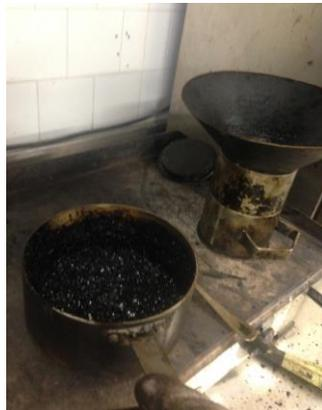
**Figura 24. Mezcla de árido y betún**
