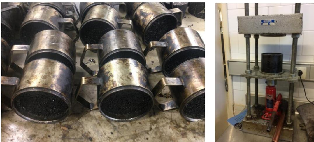
**Figura 27. Probetas enfriadas y lisas para desmoldar**
