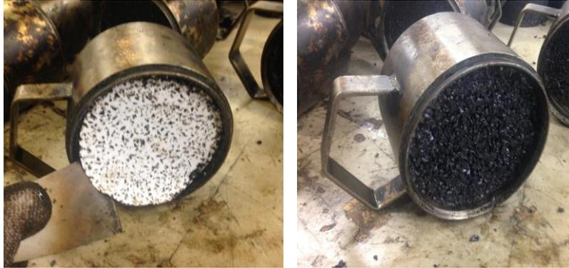
**Figura 26. Probetas compactadas**
