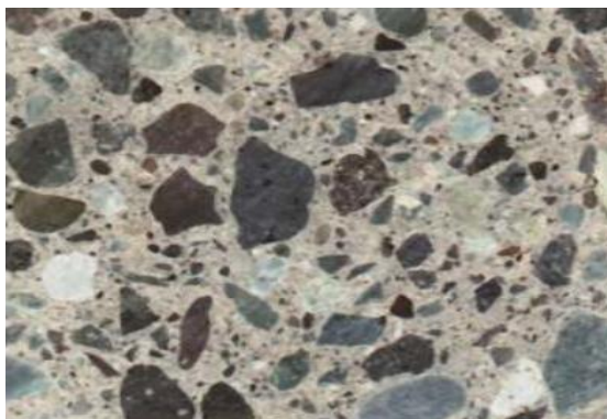
Figura 3: Estructura del formigó
