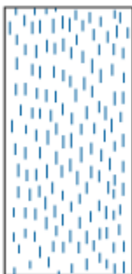
Figura 8: Esquema de fibres discontinües alineades
