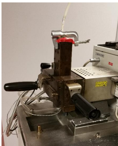
Figura 8 - Cámara de mezclado durante la aplicación del N 2
