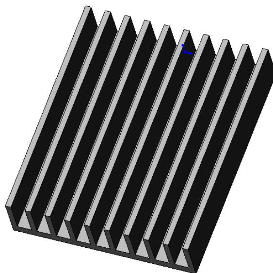
Disseny de la placa amb aletes per al controlador en Solidworks
