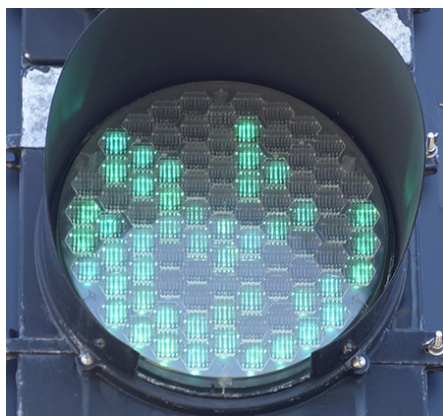
Il·lustració 8: Semàfor LED que manté la seva funcionalitat a pesar d'haver perdut alguns punts de llum
