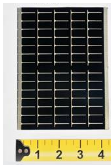
Il·lustració 6: Panell o cèl·lula solar amorfa del SisLlum
