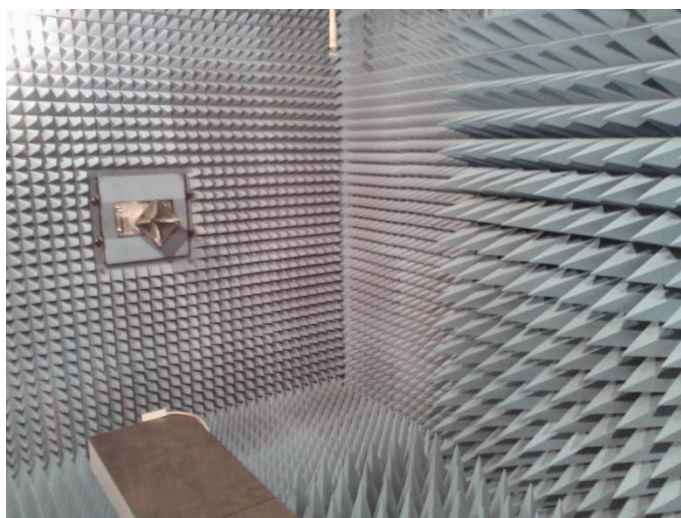
Fig. 5.25. Antena transmisora en el interior de la cámara anecoica (CTTC).
