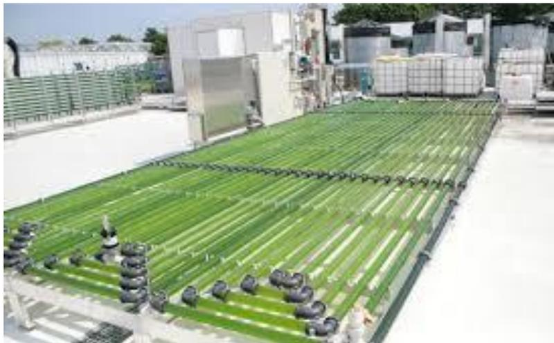
Figura 8: Fotobiorreactor tubular horizontal. Fuente: google imágenes.
