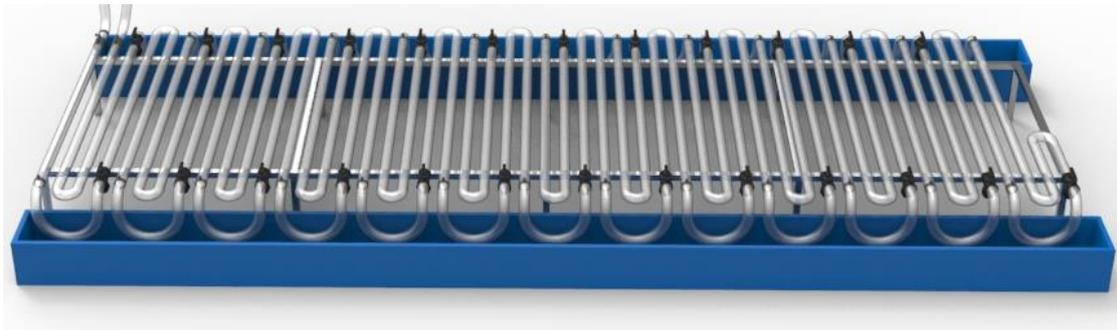
Figura 20: Diseño del sistema de refrigeración del fotobiorreactor.
