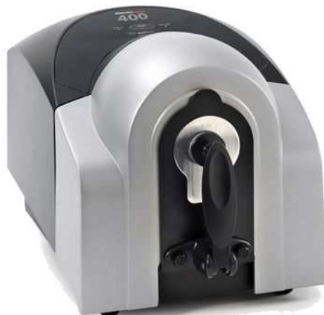
Figura 2. Espectrofotòmetre utilitzat en la mesura de la brillantor i de les solideses al fregament
