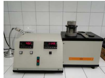
Figura 9. Esquema gràfic i imatge de l'aparell que mesura la distensió de flor d'una pell
